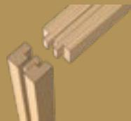
**4** В рамах выполнено угловое соединение на прорезных шипах. Такая работа обеспечивает высокую точность и повышает устойчивость конструкции.
