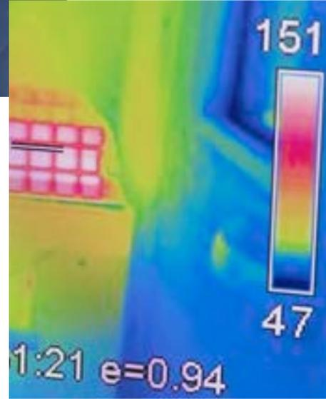
С помощью термограммы можно сделать визуализацию температуры печи, это важный аспект для повышения эффективности и соблюдения требований безопасности. Например, печь VARIUS, используемая в сауне S1 изготовлена со специальным покрытием, которое сводит к минимуму возможность получения ожогов в случае прикосновения к поверхности печи.
