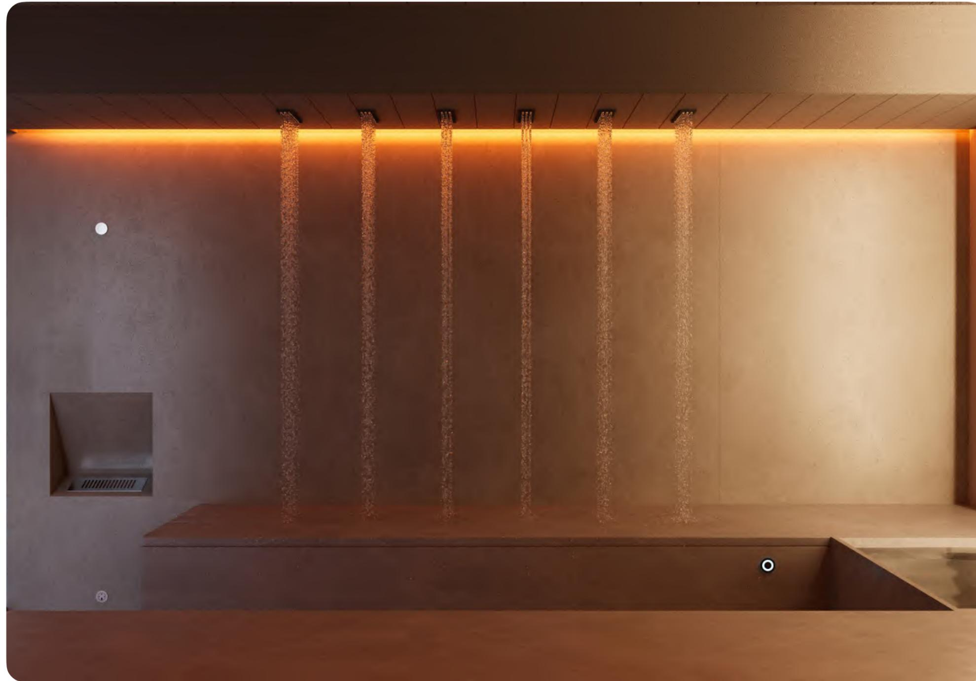
Диффузор щелевой вытяжной вентиляции спрятан в области закарнизной подсветки потолка. Контраст цветовой температуры между теплым и холодным достигается использованием 2-х типов подсветки RGB и RGBW.
